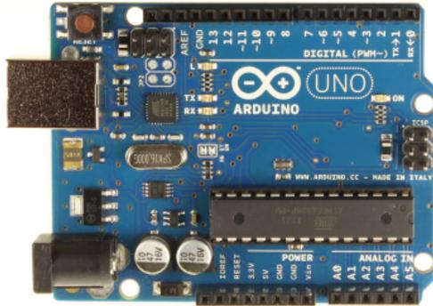
Una scheda elettronica con un microcontrollore programmabile che può pilotare dell'hardware
